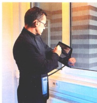
Die Übermittlung von Messdaten aus dem Laser-Messgerät in einen Windows-CE-fähigen Handheld-PC ist zwar möglich, jedoch fehlt noch eine praktikable Software, um nach der Fünf-Maß-Methode zu messen (Foto: M2K-Software)
